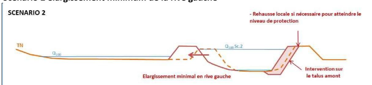
Ce scénario engendre aucun gain de section hydraulique, la digue rive gauche conserve un risque élevé de rupture, la protection en rive droite ne peut être assurée pour la crue centennale. De plus il n'est pas possible de réaliser une restauration du lit de la Leysse et de ses milieux naturels, l'impact environnemental de ce scénario est très négatif.
